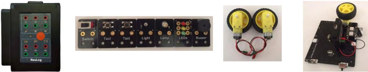
Il Sense-Make impiega unità "logiche" per comporre macchine intelligenti e robot: la tipologia costruttiva degli attuali moderni sistemi. Programmare una unità "logica" è semplice. Si indica la velocità e la direzione per programmare i motori. Si indica l'angolo richiesto per programmare il servo motore. Si indicano i valori richiesti dai sensori per programmare, e così via.
