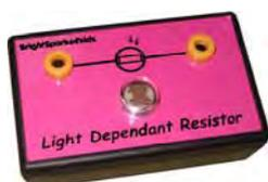
Il resistore luminoso varia la sua resistenza in funzione della quantità di luce. Viene utilizzato comunemente nei casi di l'illuminazione automatica.
