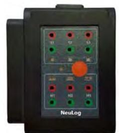
Il modulo ha due connettori per qualunque sensore NeuLog e unità di I/O intelligente. Il modulo include memoria flash per salvataggio di un programma e può funzionare indipendentemente quando viene connesso ad una batteria di backup standard. Il modulo ROBO-206 funge inoltre da modulo USB per i sensori NeuLog.
