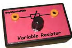
Il variatore di corrente elettrica può essere utilizzato come un controllore di velocità dell'unità motore o come interruttore crepuscolare per l'unità lampada variando l'intensità della luce. Infatti si tratta di un potenziometro che varia la corrente elettrica.
