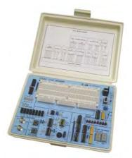
100KHz, Frequenze intermedie con l'utilizzo di un condensatore esterno - 2 Pulsanti con circuito antirimbalzo - 2 Connettori BNC utilizzabile per l'Input/Output dei segnali - 8 Switchs utilizzabili come ingressi logici - 8 Led utilizzabili come uscite logiche - 4 Latch - 2 Display a sette segmenti con relativi circuiti BCD di decodifica e accesso facilitato alle funzioni Display Enable DE, Latch Enable LE e Lamp Test LT. La fornitura include il Trainer LD2, manuale e specifico alimentatore.
