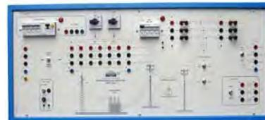
**Il simulatore simula una cabina che abbassa la tensione da 120-220-380 KV a 30- 30/Ö 3 – 10 KV e una linea 3-fase aerea di distribuzione a 30- 30/Ö 3 – 10 KV lunga 30 km.**
