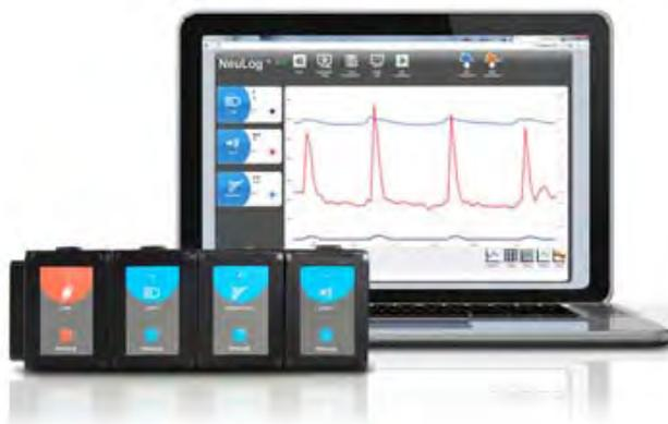
**4. Piattaforma Neulog WiFi Datalogger Chimica: Sistema innovativo Neulog per esperienze laboratoriali e scientifiche. Consente analisi, acquisizione, elaborazione e memorizzazione dati in modalità WiFi. Composto da 22 differenti moduli, SW licenza illimitata e valigetta**
