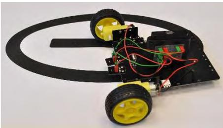
Nel package "**Sense-Make**" è incluso l'**Inventing Kit** – con cui gli studenti possono iniziare a progettare e costruire i loro propri sistemi robotici personalizzati, dotati di unità di controllo, sensori, unità decisionali e altri componenti inerenti la robotica.
