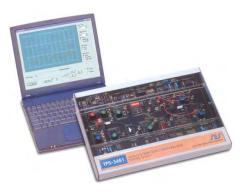
*generatore di funzioni* a onda sinusoidale e triangolare, utilizzabile anche in modo Sweep, che può essere controllato anche manualmente. Si interfaccia a PC mediante USB.
