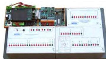
La programmazione di CRI-PLC ME avviene attraverso il tool di sviluppo SM-Remoter, che ne consente la programmazione in Ladder Diagram (LD), Instruction List (IL) e/o in **Linguaggio C**, consentendo lo sviluppo di applicazioni difficilmente approcciabili con prodotti concorrenti della stessa fascia di prezzo.
