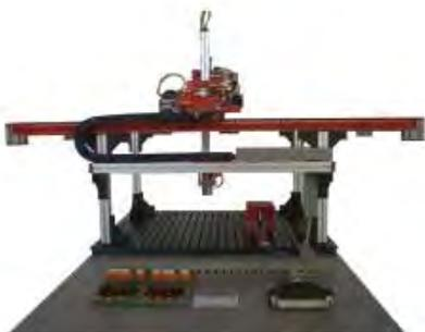
**SM220010 - Trainer impianto miniaturizzato macchina con controllo a 3 assi, compatibile con PLC.**
